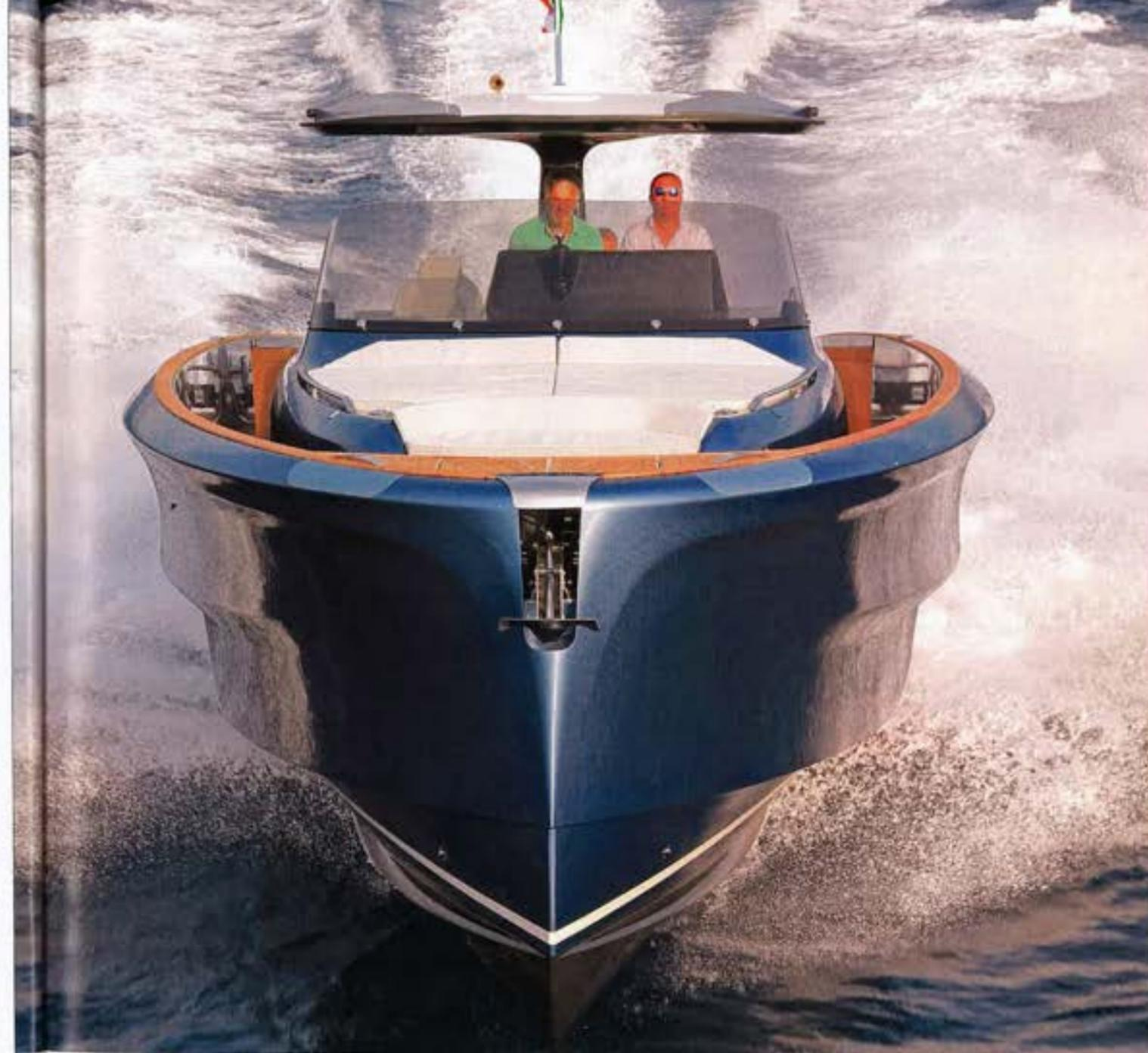
► pods IPS 650 Volvo couplés à des 480 ch D6 dans sa formule la plus puissante. Il est aussi possible d'opter pour 2 x 440 ch D6 avec des IPS 600 ou des 2 x 370 ch en standard, que l'on déconseille vivement compte tenu du poids en charge qui dépasse les 14 tonnes.
