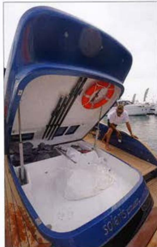
L'accès aux moteurs s'effectue via une trappe. Le capot sous le coffre du dinghy est jointé, ce qui assure une insonorisation et une étanchéité parfaites. Il faudra ôter le joint de plancher en cas d'intervention lourde.
