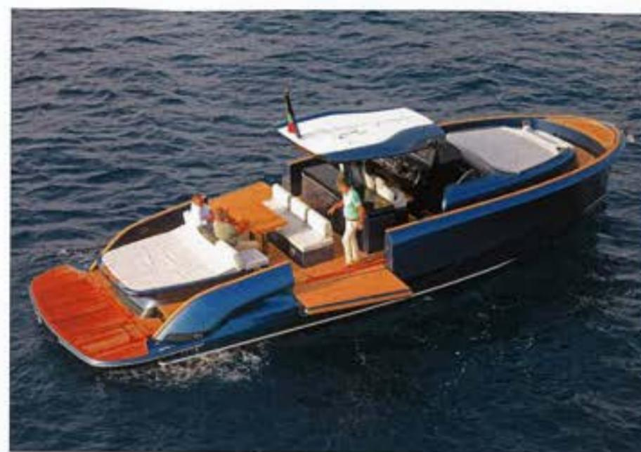
Pavois ouvrants et plateforme hydraulique immergeable, notre bateau d'essai était équipé des options les plus prisées, mais aussi les plus coûteuses (42 000 € les ouvertures latérales!).
