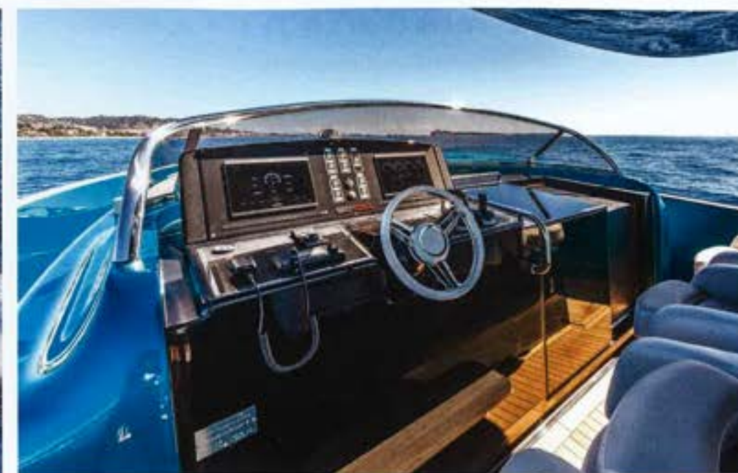
Trois fauteuils capitonnés sont installés dans le sens de la marche du bateau. La console est équipée d'écrans tactiles ainsi que des commandes numériques des IPS.
